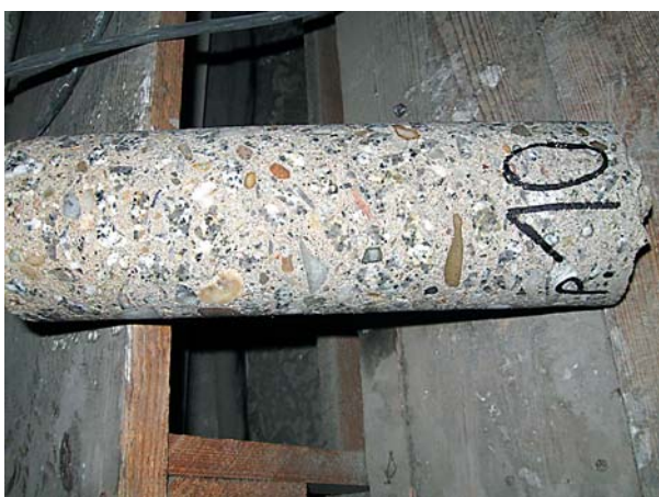
Ryc. 9. Widok struktury badanego betonu na przykładzie odwiertu nr 10 Fig. 9. View of the examined concrete structure on the example of bore-hole no 10
