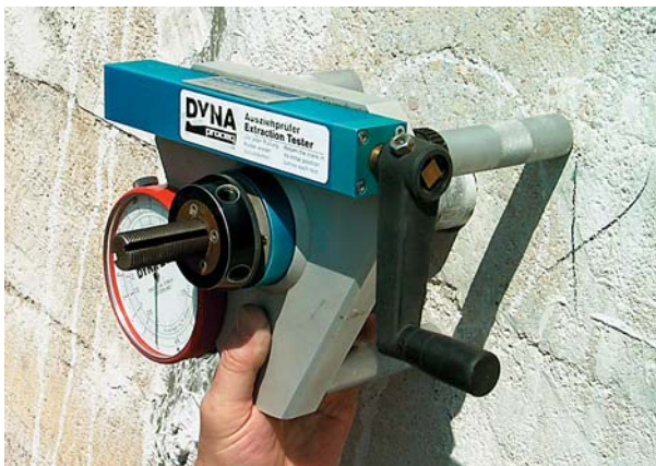
Ryc. 6. Widok urządzenia o nazwie „DYNA” wykorzystanego do pomiaru wytrzymałości betonu na rozciąganie (odrywanie) Fig. 6. View of the device called “DYNA” used for measuring the tensile strength of concrete (peel strength)
