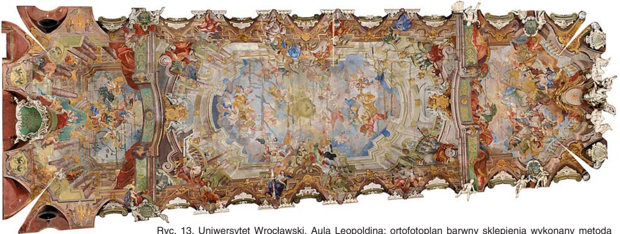
Ryc. 13. Uniwersytet Wrocławski, Aula Leopoldina; ortofotoplan barwny sklepienia wykonany metodą fotogrametryczną i metodą skaningu laserowego, rozdzielczość terenowa (wymiar piksela) 2,00 mm Fig. 13. University of Wrocław, Aula Leopoldina; colour orthophotomap of the vault made using photogrammetric method and laser scanning method, area resolution (pixel size) 2.00 mm
