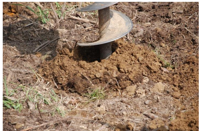
Abbildung 68: Bohrspindel mit 30 cm Durchmesser
