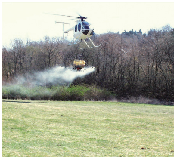
Obř. 5-4 Vrtulník Hughes 369 E s aplikačním zařízením při kalibraci letu
