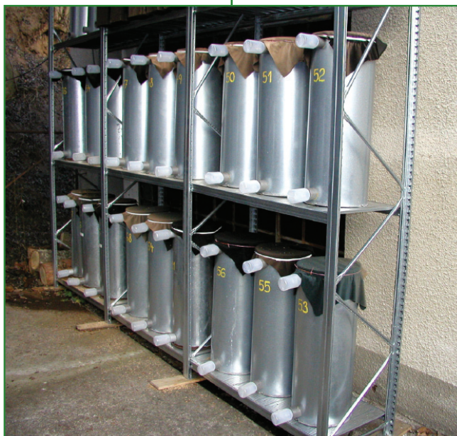
Obr. 5-6 Chovná zařízení (fotoeklektory) pro líhnutí podkorního hmyzu z dubových polen
