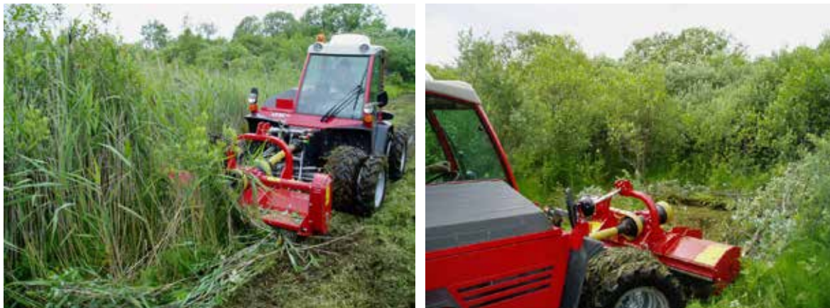
Obr. 11. Príklad ľahkého traktora (malotraktor Aebi Rasant Terratrac TT55 s mulčovačom Seppi 175), ktorý má široké kolesá a je adaptovaný na mokraďové podmienky. V ťažkom zarastenom teréne je schopný vyčistiť a pomulčovať asi 1 hektár slatinných lúk za deň. Foto: T. Dražil
