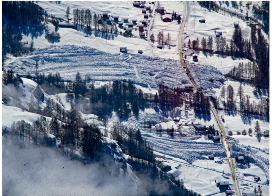
Abb. 9. Unglückslawine in Evolène (Wallis) vom 21.2.1999. Die Lawine brach in mehreren Anrissgebieten auf einer totalen Breite von rund vier Kilometern an. Die Schneemassen töteten 12 Personen und richteten grossen Sachschaden an. Zwei Lawinenarme überflossen die Kantonsstrasse, die auf einer Länge von 160 m rund 6 m hoch verschüttet wurde (Foto S. Margreth, SLF, 25.2.1999).
