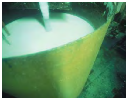
A fagorgácsot folyadékba helyezik, hogy papépet készítsenek belőle
