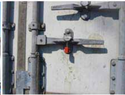
⑥コンテナをシールし、出発港へドレージ
