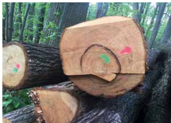
Abbildung 5: Edelkastanienstammholz mit Ringschäle Foto: W. Wambsganß
