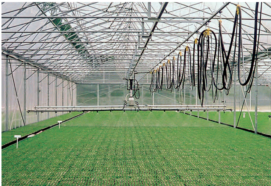
Ruchoma rampa deszczująca – nawadnianie siewek w namiocie foliowym (Szwecja)
