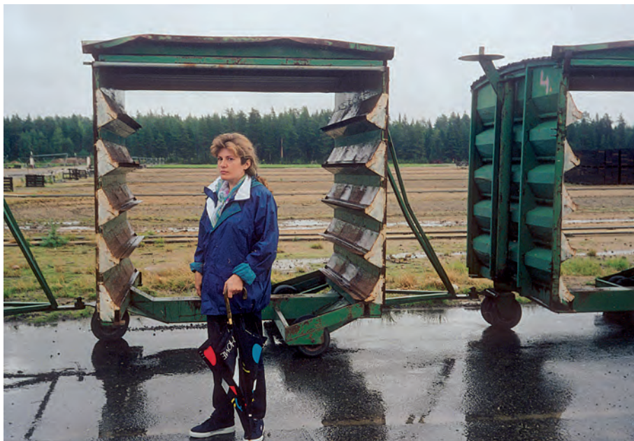
Stelaże do transportu sadzonek, używane w Szwecji przez firmę NOMEKO
