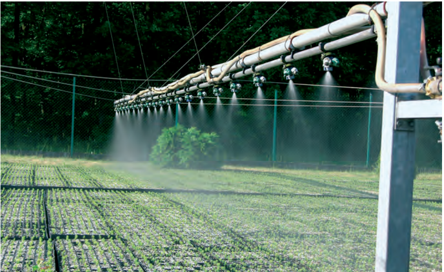
Ruchoma rampa deszczująca siewki świerka pospolitego wywiezione z namiotu na otwarte pole hodowlane (Nadleśnictwo Rudy Raciborskie)
