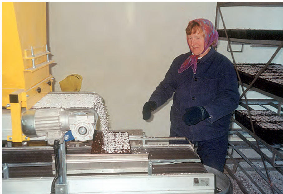
Urządzenie do zasypywania wysianych nasion drobnym perlitem
