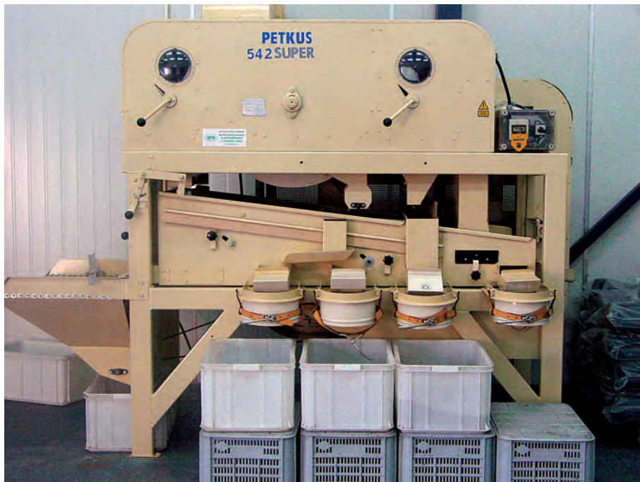
Wialnia sitowo-pneumatyczna do wstępnego oczyszczania nasion (Nadleśnictwo Rudy Raciborskie)
