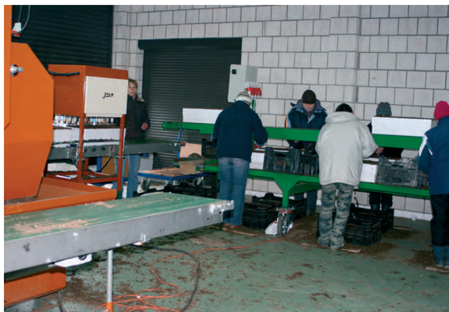
Linia do ręcznego siewu żołądźi i innych dużych nasion (Nadleśnictwo Gidle)
