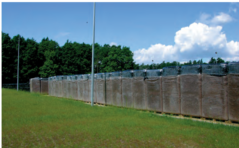
Surowy torf importowany jest najczęściej w opakowaniach typu Big Bale o pojemności 4–6 m 3
