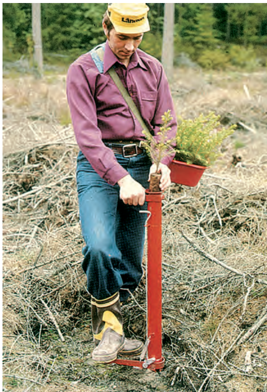
Kostur do sadzenia sadzonek z bryłką (produkcji fińskiej firmy LANNEN)
