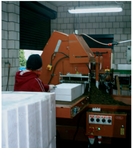
Urządzenie do napelniania kontenerów styropianowych w szkółce kontenerowej Nadleśnictwa Gidle
