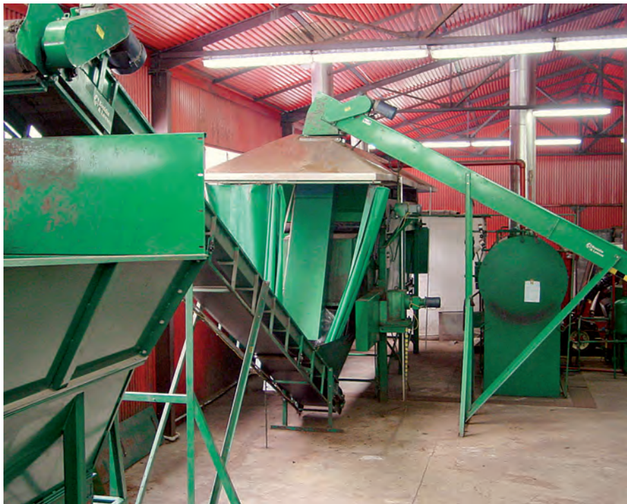
Fragment linii do produkcji substratów torfowych w szkółce kontenerowej Nadleśnictwa Rudy Raciborskie
