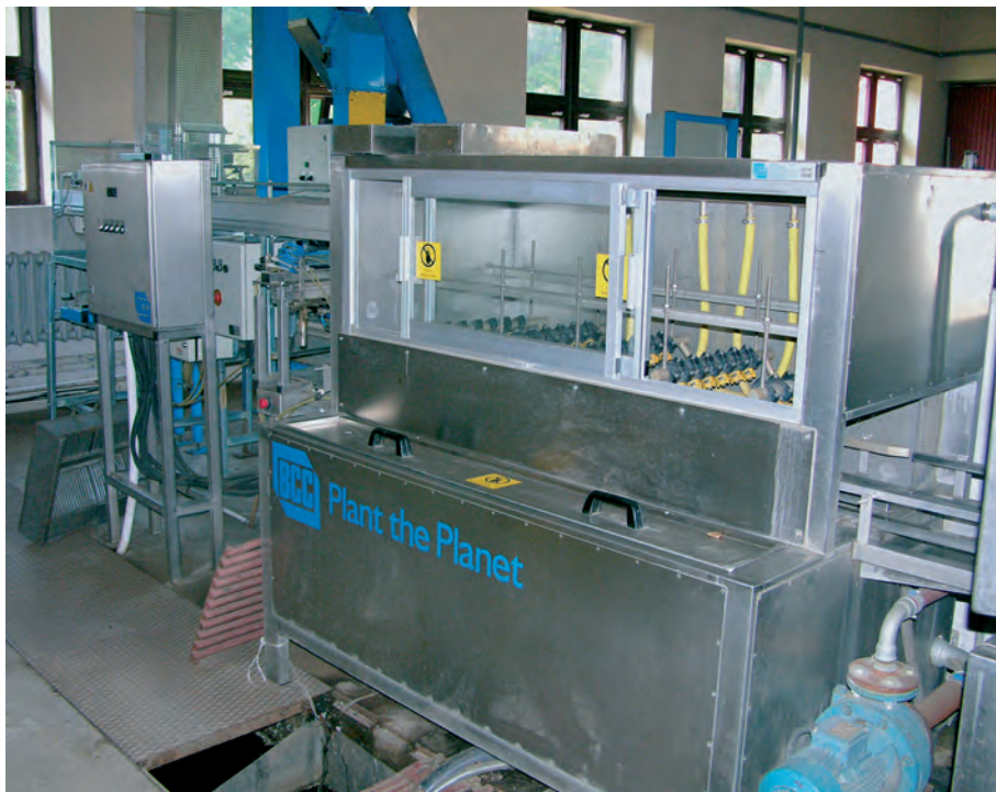
Myjnia kaset – jeden z elementów automatycznej linii napełniania kontenerów (Nadleśnictwo Rudy Raciborskie)
