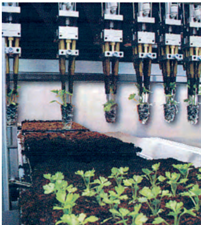
Urządzenie do szkółkowania sadzzonek z mniejszych do większych pojemników
