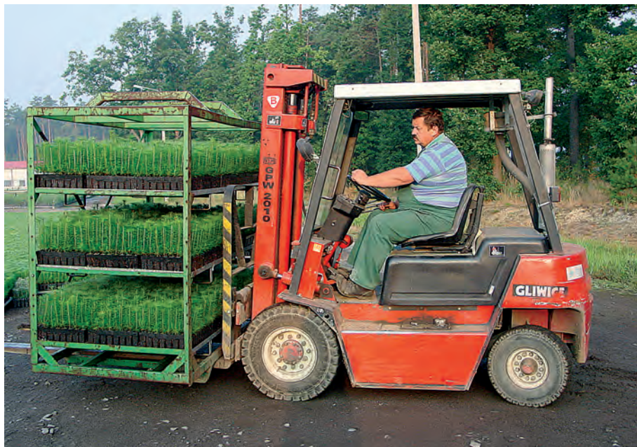
Transport wewnętrzny (w obrębie szkółki) za pomocą wózków widłowych; na zdjęciu stelaż transportowy z trzema paletami sadzonek sosny zwyczajnej (Nadleśnictwo Rudy Raciborskie)
