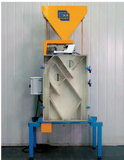
Separator grawitacyjny do precyzyjnej separacji nasion (Nadleśnictwo Rudy Raciborskie)
