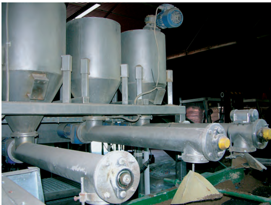
Zestaw urządzeń dozujących składniki substratu – linia do produkcji substratu w Nadleśnictwie Rudy Raciborskie
