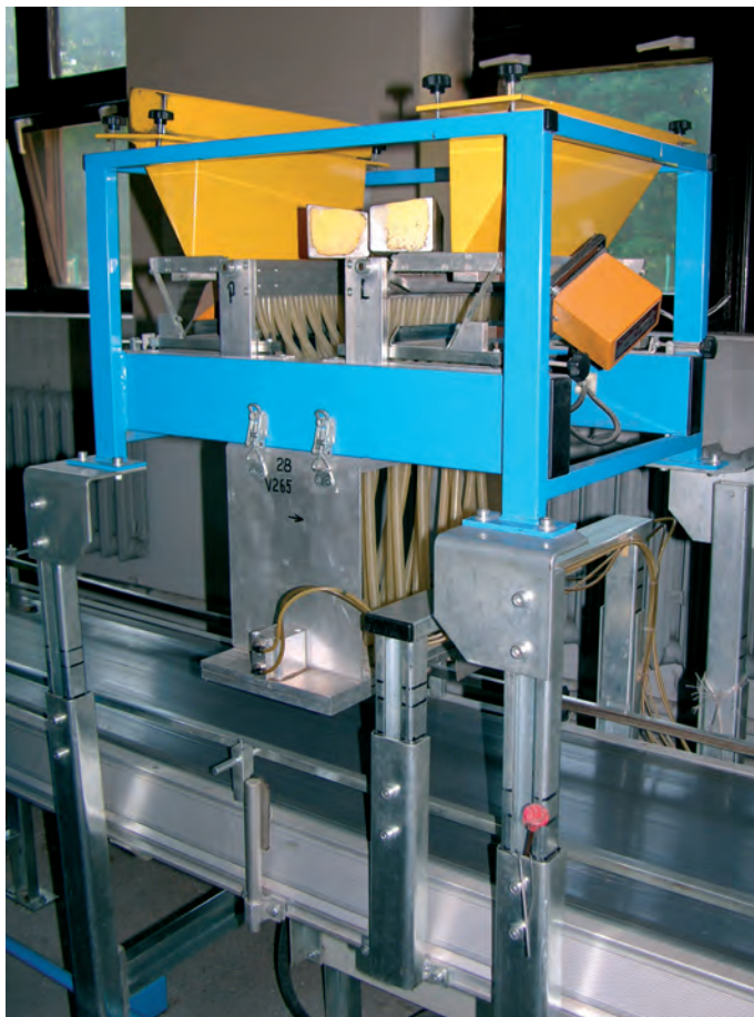
Precyzyjny, automatyczny siewnik do suchych i drobnych nasion (Nadleśnictwo Rudy Raciborskie)
