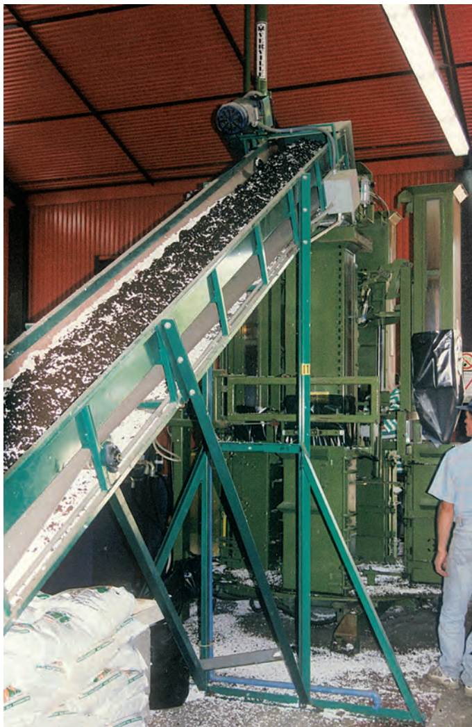
Hala do produkcji substratów torfowych w szkółce kontenerowej Nadleśnictwa Rudy Raciborskie – widoczne urządzenie do prasowania i pakowania w worki gotowego substratu
