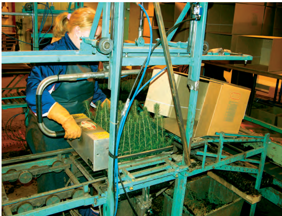
Linia do półautomatycznego pakowania sadzonek do kartonów w celu umieszczenia w chłodni (Szwecja)
