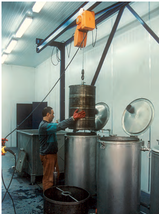
Linia do termoterapii żołądźi – moment umieszczania kosza z żołądźiami w kotł z gorącą wodą (Nadleśnictwo Rudy Raciborskie)
