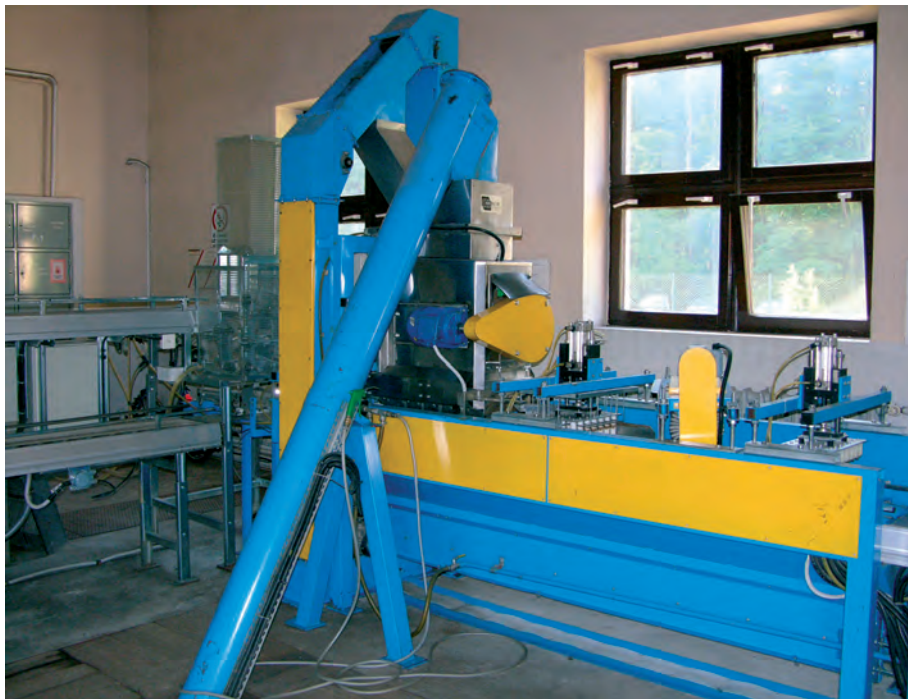
Automatyczna linia napełniania kontenerów i siewu nasion w szkółce kontenerowej Nadleśnictwa Rudy Raciborskie
