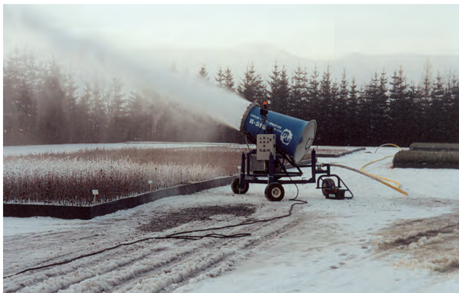
Sztuczne zaśnieżanie sadzonek za pomocą armatki śnieżnej – Nadleśnictwo Śnieżka
