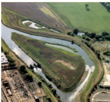
Ryc. 4. Przepławka typu „obejście” na rzece Don, Wielka Brytania
