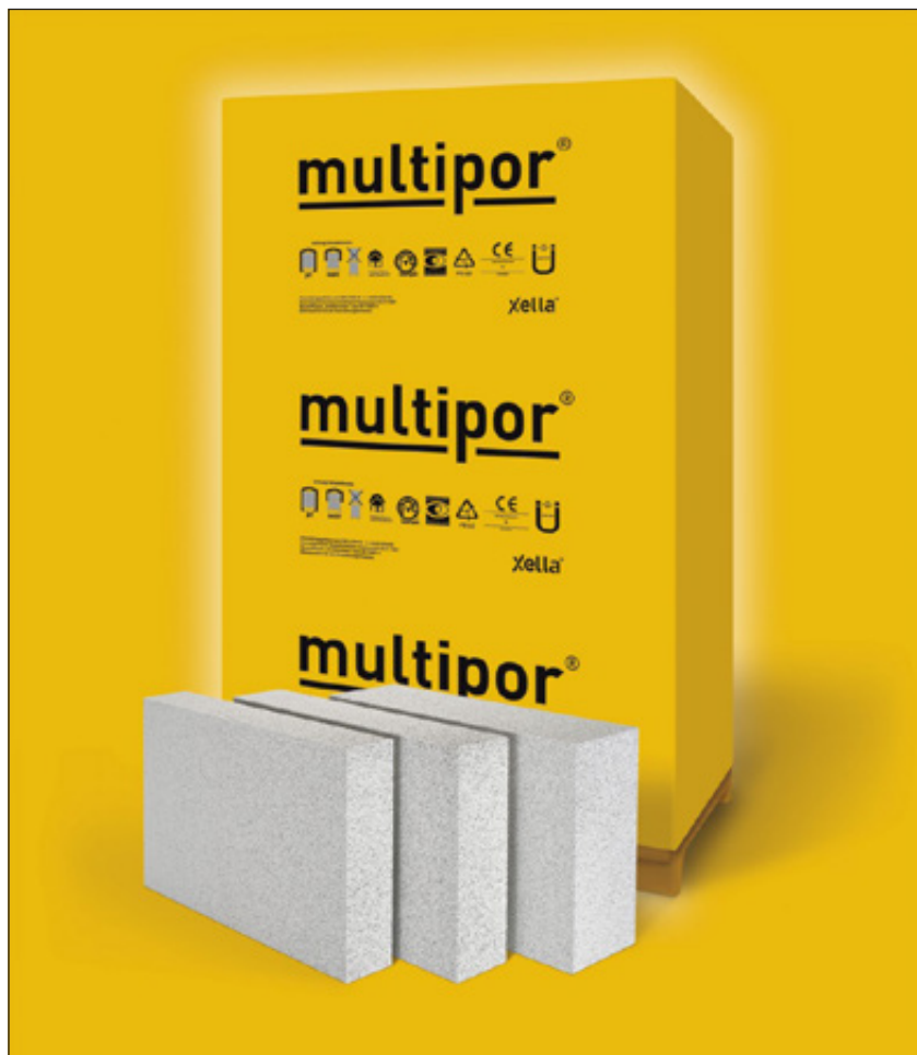
Płyty Multipor wykonane są z bardzo lekkiej odmiany betonu komórkowego o gęstości 115 kg/m 3 . Dzięki temu jest to materiał o wysokiej termoizolacyjności ( \lambda_D = 0,043 W/mK), paroprzepuszczalny ( \mu = 3 ) oraz niepalny (klasa A1 reakcji na ogień).
