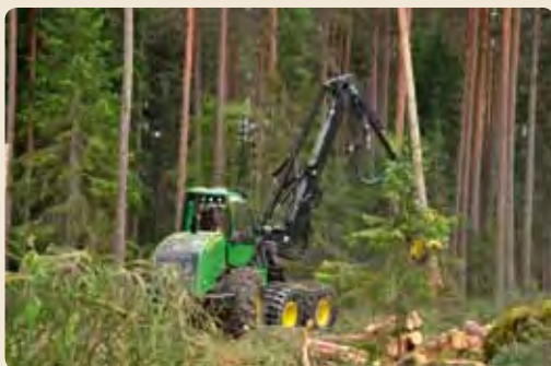
En stor modern engreppsskördare, JD 1470E. Maskintypen tillhandahålls av alla tillverkare och har blivit dominerande för all avverkning, från gallring till slutavverkning.
