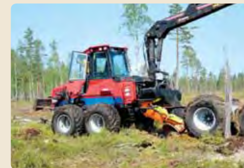
Skogsvården har visat sig svårare att mekanisera än avverkningsarbetet. Här pågår försök med skonsam markberedning enligt inversmetoden, där en torva vänds upp och ner av en plogtallrik. Förhoppningen är att kunna kombinera denna metod med plantering.
