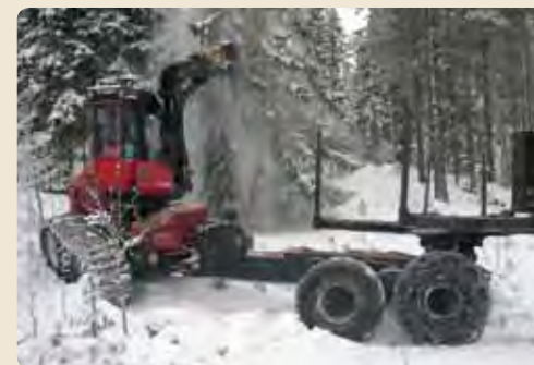
En drivare – Valmet 801 – kombinerar arbetsuppgifterna för skördare och skotare och kan fälla, upparbeta, lasta och transportera träden. Maskintypen har ännu inte fått något genomslag, trots omfattande försök och tester.
