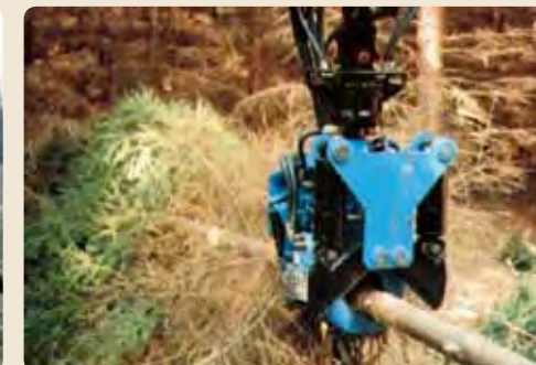
SP21 var det första svenska engreppsskördare-aggregatet. Det hade kapacitet att fälla och kvista träd upp till 20–25 cm diameter och var avsett att användas i gallring. Då aggregat i större storlekar utvecklats slog engreppsskördaren även igenom i slutavverkning.
