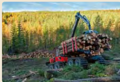
En stor modern skotare, Komatsu 895. Banden ger extra bärformåga och skonar marken. Foto: Komatsu
