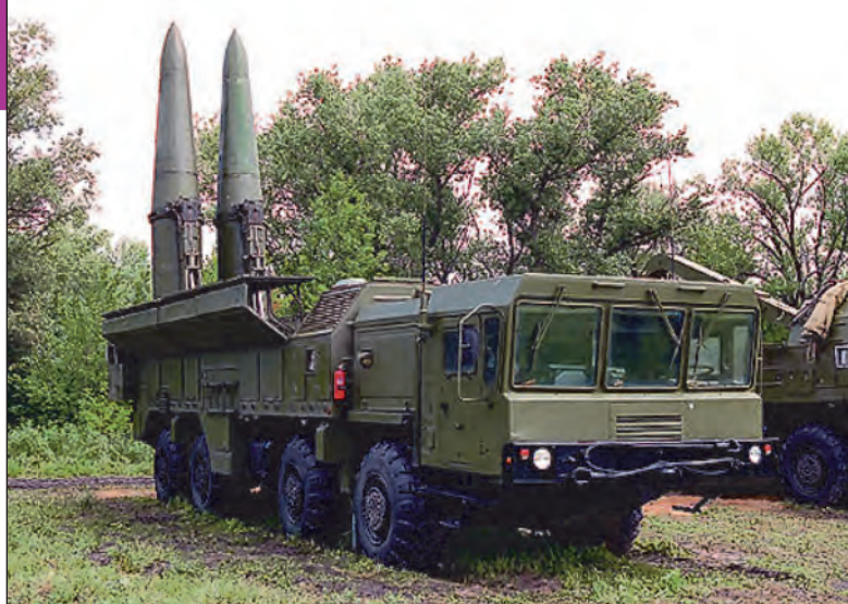
48. ábra. R-500-as Iszkander rakéta rendszer 9P78-as szállító-indító járműve
