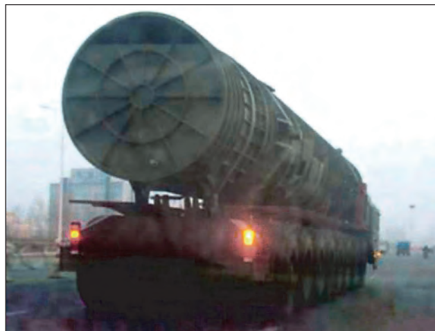
46. ábra. DF-41-es interkontinentális ballisztikus rakéta szállító-indító jármű hátulnézete
