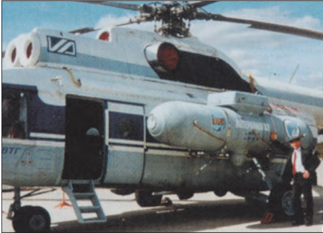
12. a) és b) ábra. Mi-8 helikopter propán-bután üzemre átalakítva
