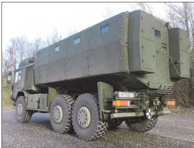
15. ábra. A magas szintű védettséget biztosító RÁBA H860.01 típusú, páncélozott védett zárt felépítmény
