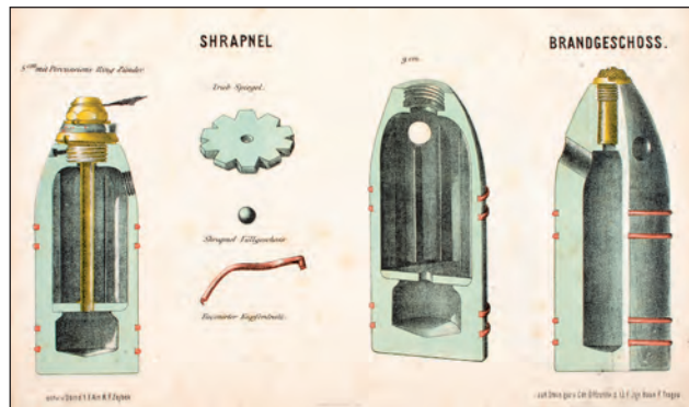
10. ábra. Uchatius ágyúlőszerének metszete
