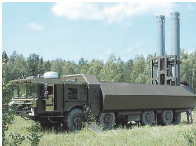
53. ábra. Bal-E partvédelmi rendszer K-340P szállító-índító járműve, két Onix robotrepülőgéppel
