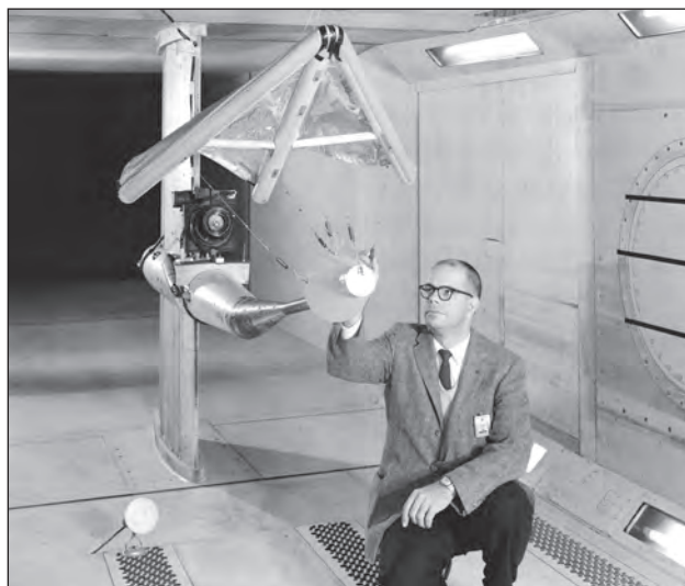
44. ábra. Kezdetben elképzelhetőnek tartották a Rogallo-siklószárny alkalmazását. Itt egy szélcsatornás vizsgálat zajlik
