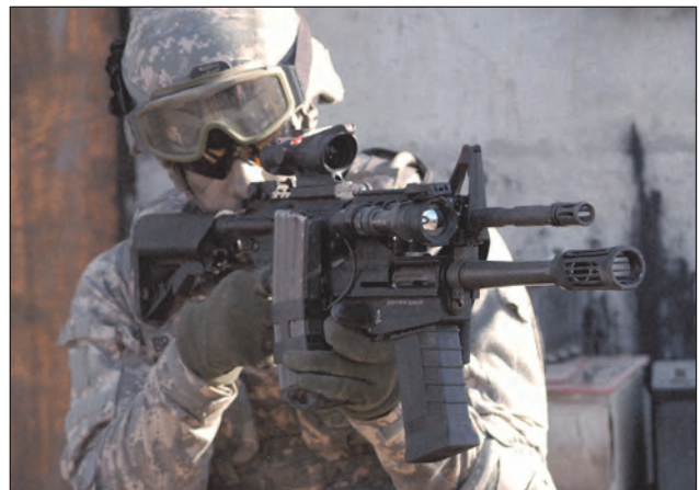
7. ábra. 12-es kaliberű M26-os simacsövű kiegészítővel (Shotgun modulárral) felszerelt M4-es gépkarabély. Tüzelhető: különböző méretű sörétek, gyöngygolyó, páncéltörő lőszer, illetve gumilövedék. A fegyver mellé rögzített tár a gyors tárcserét teszi lehetővé
