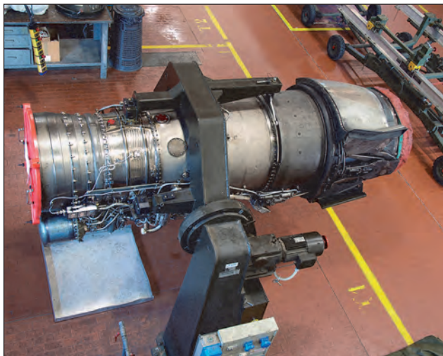
23. ábra. Turbo Union RB199-34R 103-as gázturbina, a Tornádo hajtóműve
