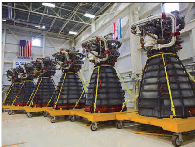
9. ábra. Ellenőrzésre váró Rocketdyne RS-25-ösök, vagyis SSME-k. Végül nem váltották be a hozzájuk fűzött összes reményt: minden indítást követően alkatrészenként ellenőrizni kellett őket
