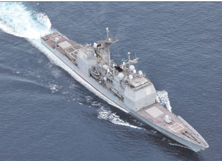
13. ábra. Jól látható az AN/SPY-1 négy antennájából kettő: az egyik a felépítmény elején a hajóhid ablaksora alatt, a másik a hátsó szekció oldalán
