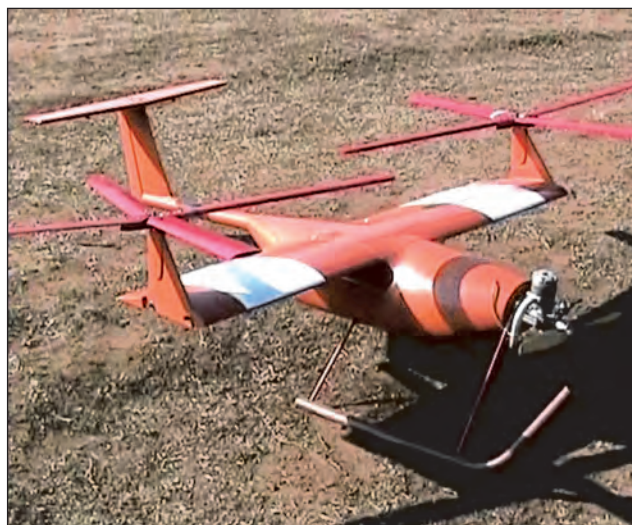
4. ábra. Autogiróvá átalakított, de szárnyfelülettel is rendelkező Meteor-2 célrepülőgép
