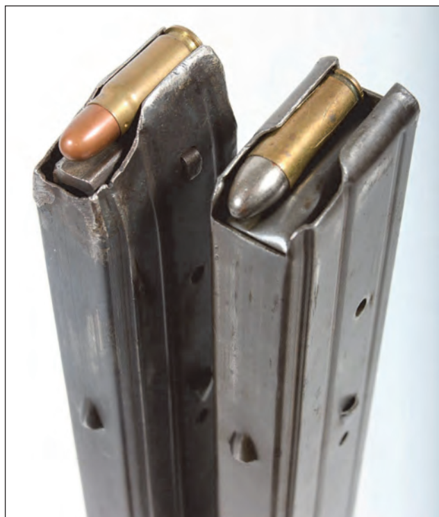
10. ábra. Jobbra az 1943M géppisztoly „hagyományos” tára Mauser Export tölténnyel, balra az átalakított tár TT lőszerrel
