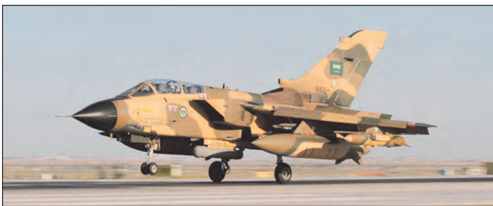
25. ábra. A Szaudi Királyi Légierő Tornádo IDS harci repülőgépe a modernizálást követően a Litening célmegjelölő konténerrel is hordozhatja
