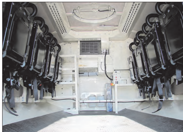
17. ábra. A páncélozott felépítmény belső tere. Az energiaellátó ülések sora között a tetőlemezen jól látható a kör alakú búvónyílás
