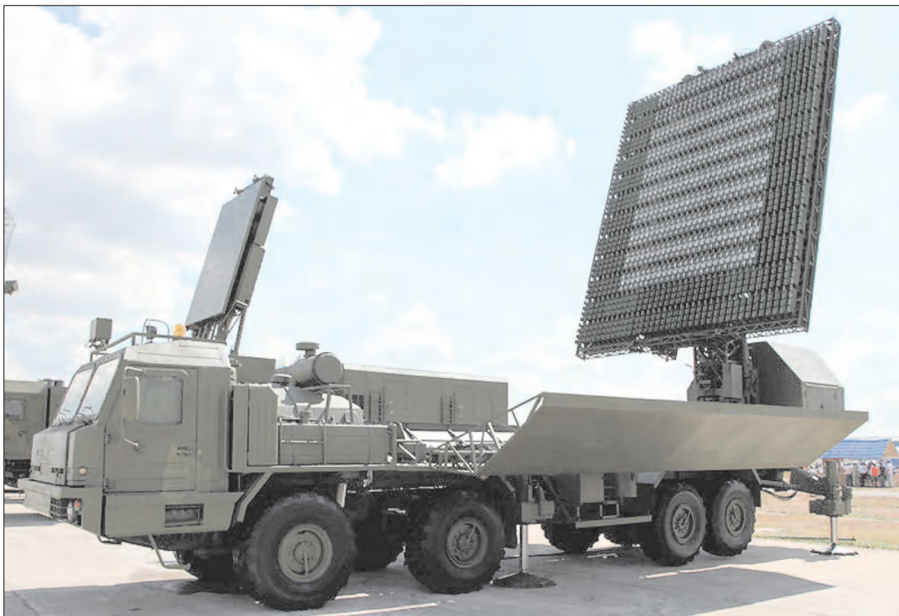
58. ábra. Nyebó-ME fázisvezérelt radar (56Zs6ME) MAZ-6909-015-ös alvázon
