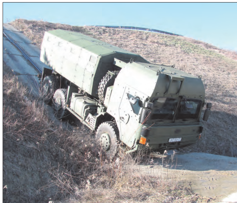
20. ábra. A RÁBA VZF páncélozott katonai terepjáró jármű nagyfokú terepjáró képessége biztosítja a gyors mozgást nehéz terepen is. A képen 30°-os lejtő és emelkedő, illetve vizesárok leküzdése látható
