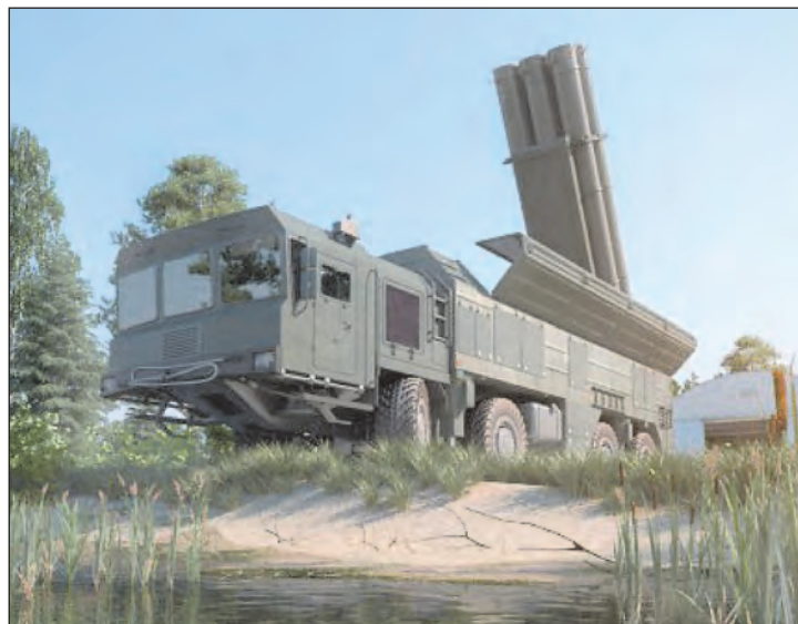
54. ábra. Klub-M partvédelmi rendszer szállító-índító járműve, hat Onix robotrepülőgéppel
