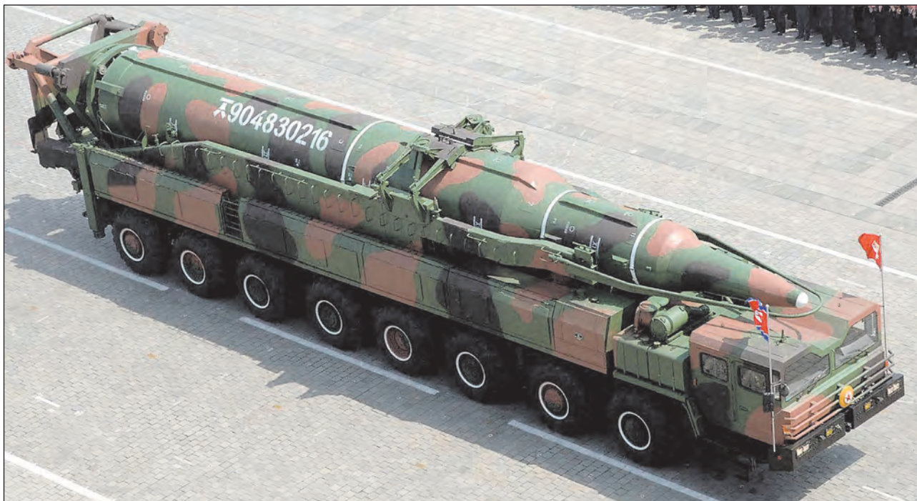
45. ábra. WS-51200-as kínai önjáró alváz ballisztikus rakétával Phenjanban, a 2012. április 15-i díszszemlén
