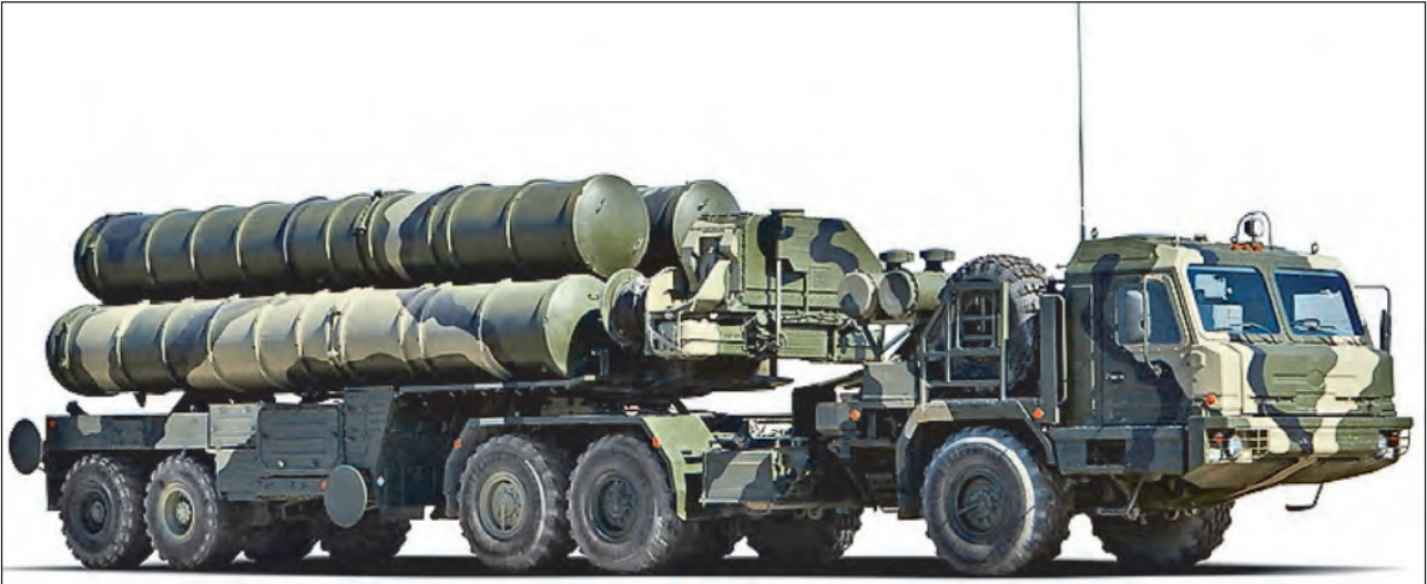
55. ábra. BAZ-6402-es nyerges vontató, Sz-400-as Triumf-rendszer 5P85TE szállító-indító utánfutóval
