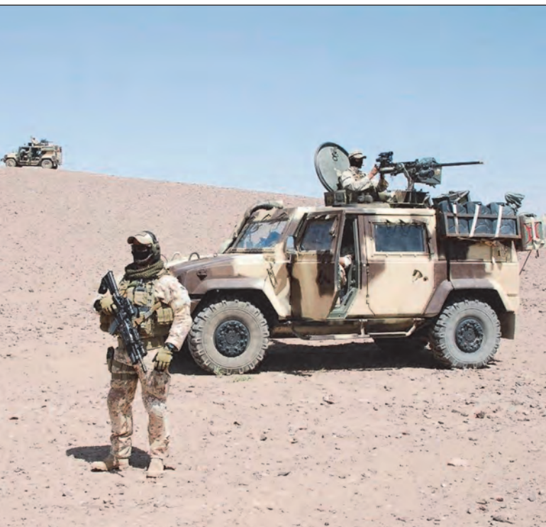
9. ábra. Könnyű gépjárműekre málházott különleges műveleti csoport. A katona kezében egy 40 mm-es M203-as gránátvetővel és különféle optikai irányzékokkal felszerelt M4-es gépkarabély látható, míg a járművön egy 12,7 mm-es (.50-es) nehéz géppuskát helyeztek el támogató fegyverként
