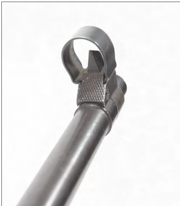
8. ábra. Az 1943M géppisztoly célgömbtőkét tartó gyűrűn jól látszik az elfordulás során keletkezett 2-3 mm-es kopás
