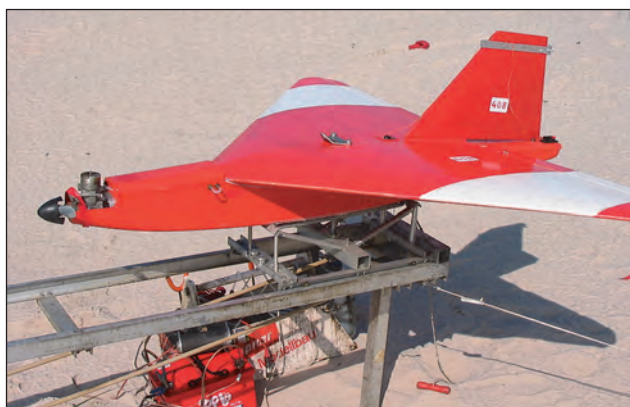
2. ábra. A 6 m hosszú alumínium állványról gumiköteles gyorsítással indult a Meteor-1
