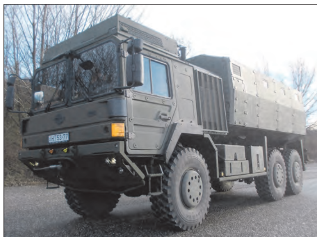
14. ábra. A RÁBA H18.240 DAEZ-111 típusú katonai terepjáró járművet a missziós feladatok biztonságos ellátása érdekében szerelték fel védett zárt felépítménnyel
