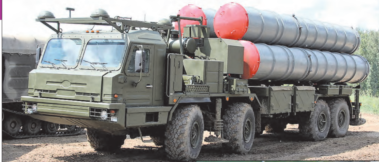
60. ábra. Sz-400-as Facorit rakéta-rendszer 5P90S szállító-índító jármű BAZ-7909-022-es alvázon
