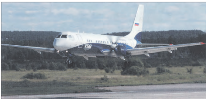
13. ábra. Gáz üzemanyagra átállított IL-114-es regionális szállító repülőgép
