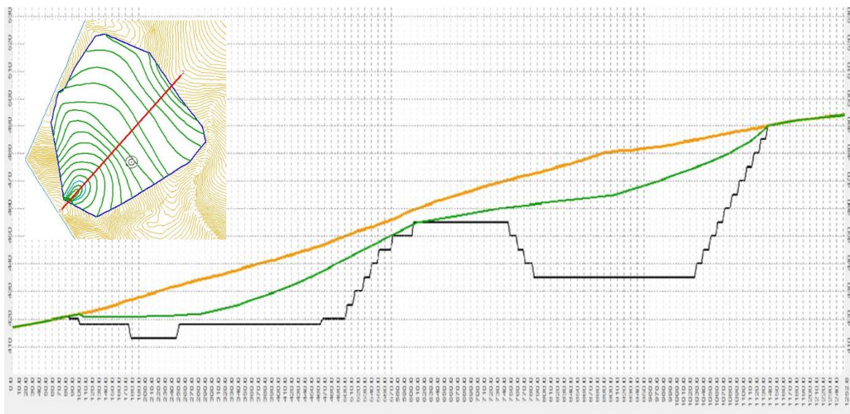
Obrázek 14: Řez terénem před těžbou a po sanaci
