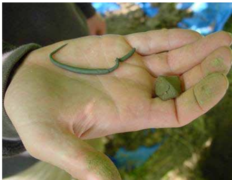
Die Fingerprobe zur Bodenartbestimmung und der Salzsäuretest zur Kalkbestimmung sind wichtige Beurteilungsparameter für den richtigen Douglasienstandort.
