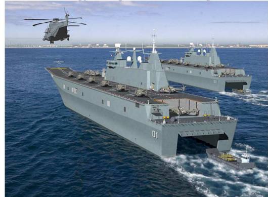
60. kép A Canberra-osztályú hajók több funkció deszant hajók, tehát tengeri és helikopteres deszant kijuttatására is alkalmasak. Illetve ha Ausztrália vásárol F-35B-eket is, akkor könnyű repülőgép hordozóvá is válhatnak, erre utal a hajók orrán a síugrósánc is.
