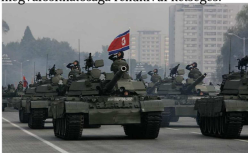
77. kép A legkorszerűbb északi harckocsi a Pokpung, amely a T-62 továbbfejlesztésén alapszik, amely technológiailag messze a K1, K2 és M1 mögött van.
