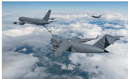
124. kép A tanker képesség elengedhetetlen a modern légi műveletek során. A képen egy KC-46A tölt fel egy C-17-t.
