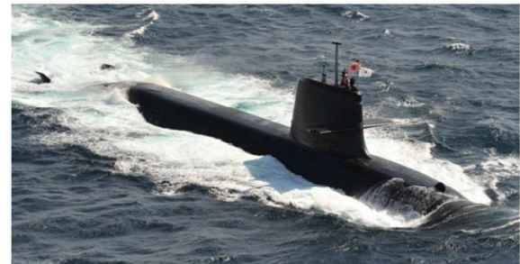
25. kép A Soryu-osztályú dízel-elektromos tengeralattjárók világszínvonalat képviselnek és hatékony tengeri ellenőrző, területmegtagadó és felderítő egységeket jelentenek a JMSDF számára.
