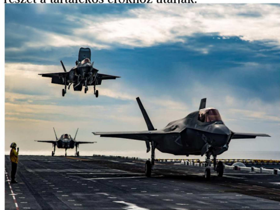
133. kép A USMC rendszeresíti az F-35B/C típusokat is. A STOVL F-35B képes a helikopter-hordozókról és kiépítetlen szárazföldi bázisokról is üzemelni. Sőt, segítségével az LHD és LHA hajók könnyű repülőgép-hordozóként is funkcionálhatnak.
