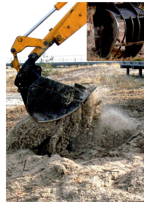
Fot. 1. Czerpak koparki przystosowany do usuwania systemów korzeniowych i kłączy róży. 28.02.2014 (fot. J. Herbich).
