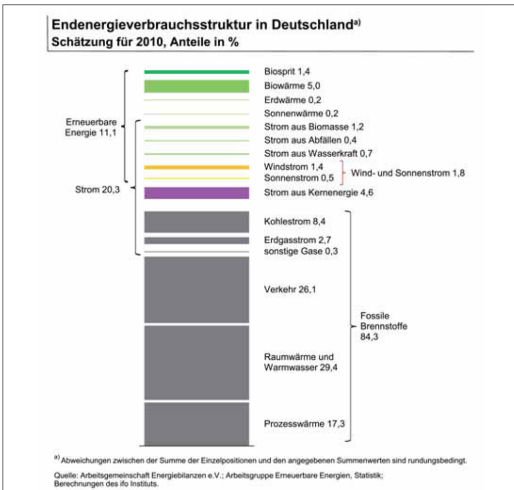
Abb. 8: Endenergieverbrauch 2010, aufgeschlüsselt nach Energiequellen und Verbrauchssektoren (SINN 2011).
