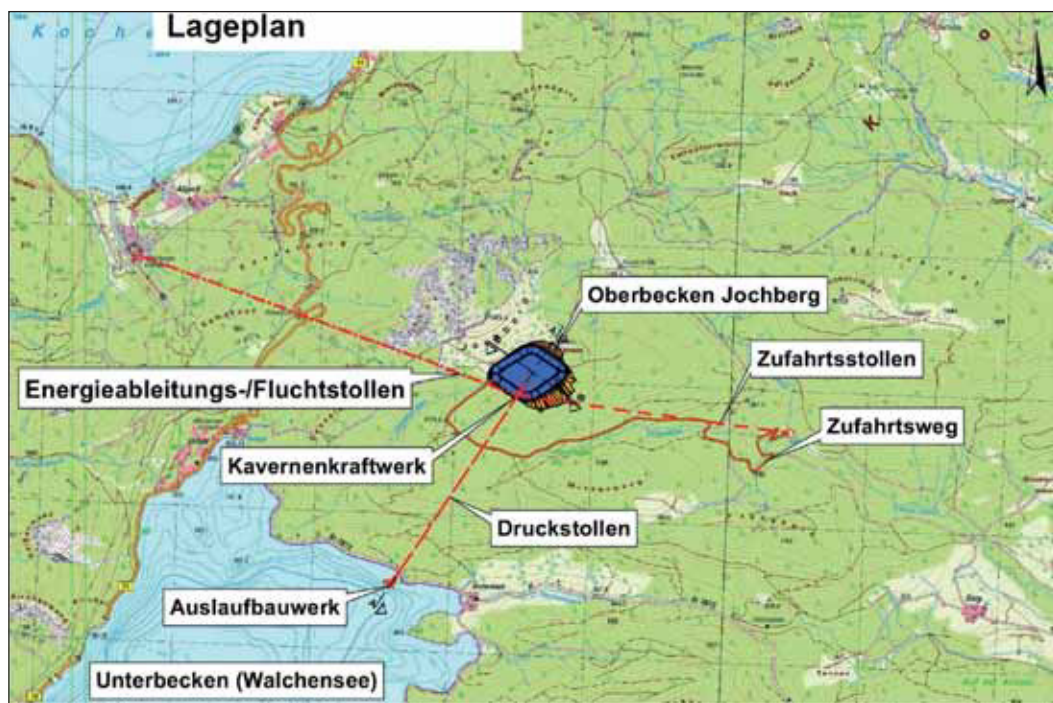
Abb. 1: Das PSW am Jochberg oberhalb von Kochel- und Walchensee; von der EAB der Öffentlichkeit präsentierte Karte im Februar 2013. 3 (© HPI).
