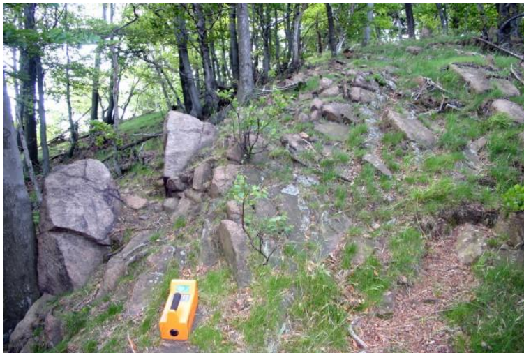
Obrázek 4-2 Terénní in-situ měření obsahů radioaktivních prvků přenosným gama-spektrometrem. Foto. V. Rappich.
